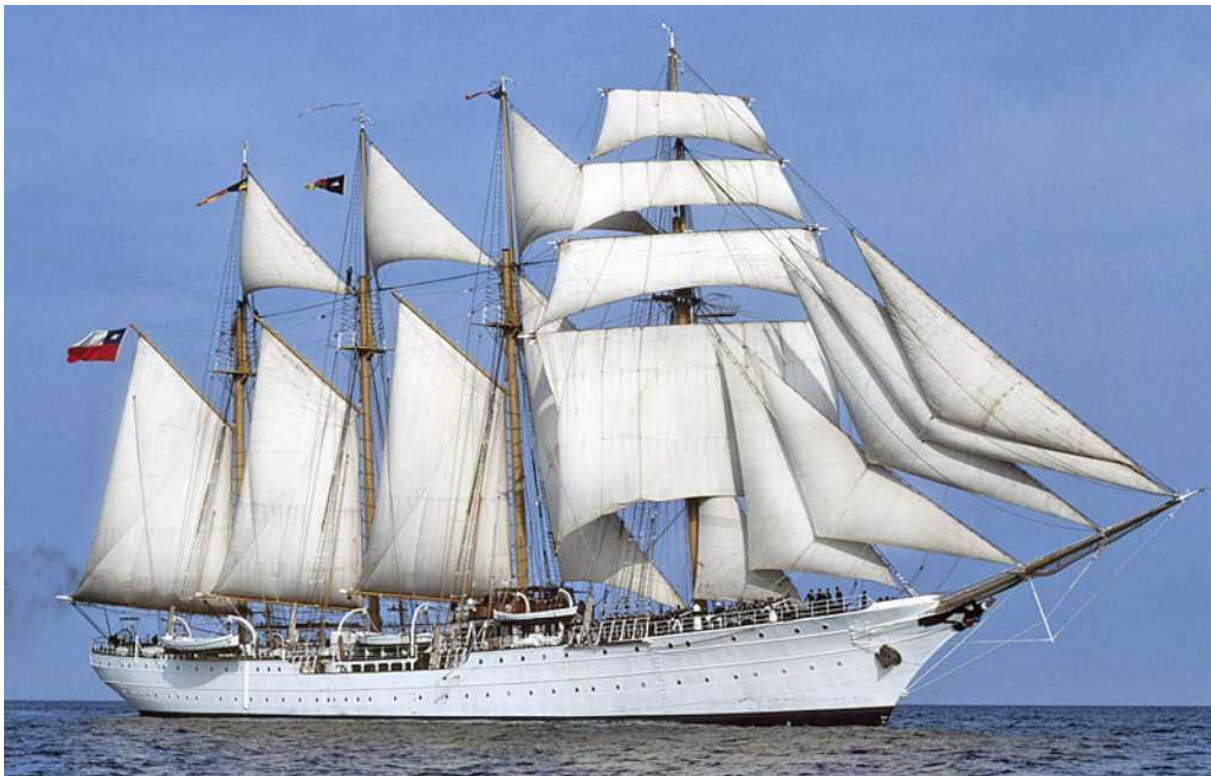
Die elegante Viermast-Barkentine ESMERALDA trägt im Gegensatz zu ihrem spanischen Schwesterschiff am Fockmast nur Rahsegel. Foto: Armada de Chile, nicht datiert.
